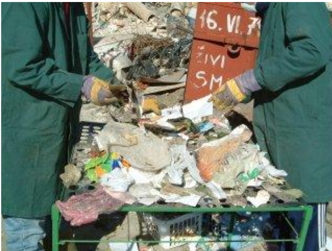
SLIKA 2 – RUČNO SORTIRANJE NA PERFORIRANOM STROJU
